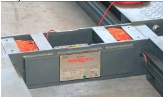
Viga transversal central montada con módulos metálicos. Podemos ver los cables de conexión de las células
